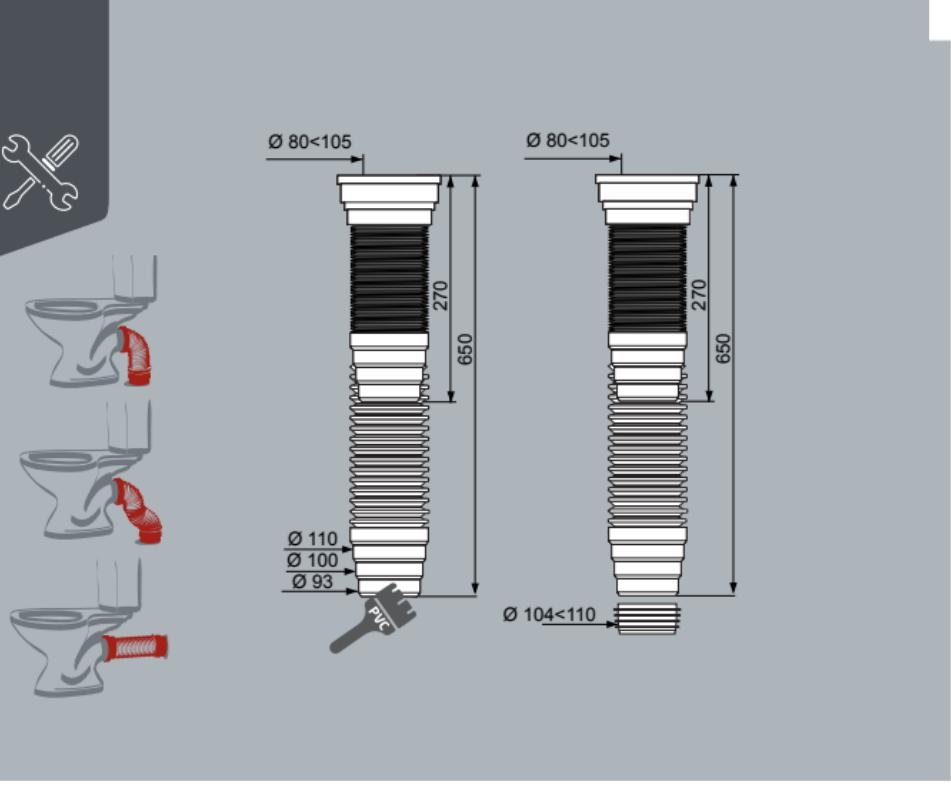
**MODE D'EMPLOI :** Dépolir la canalisation pour assurer une bonne adhérence de la colle. Graisser ou savonner le joint pour faciliter l'emboîtement sur la cuvette.
