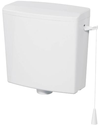
Le réservoir REISO de WIRQUIN est un réservoir apparent complet prêt à être installé. Il est équipé d'un mécanisme double chasse pour faire des économies d'eau et d'un robinet flotteur silencieux. Le réservoir est équipé d'une butée arrière et d'une entretoise pour garantir sa stabilité. D'un look classique, le REISO est fabriqué en plastique, est plus léger et facile à installer.
