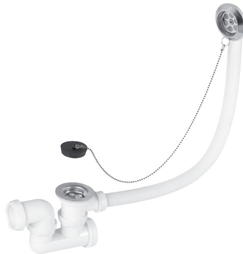
Cet ensemble complet conçu, pour équiper les baignoires, inclut une bonde, un trop-plein et un siphon orientable avec garde d'eau de 50 mm efficace contre les remontées d'odeurs.
