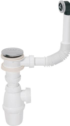
Cet ensemble complet, conçu pour équiper un lavabo avec trop-plein extérieur, comprend une bonde et un siphon classique de qualité. Réglable en hauteur et disposant d'une garde d'eau de 50 mm, cet ensemble de lavabo est efficace contre les remontées de mauvaises odeurs.
