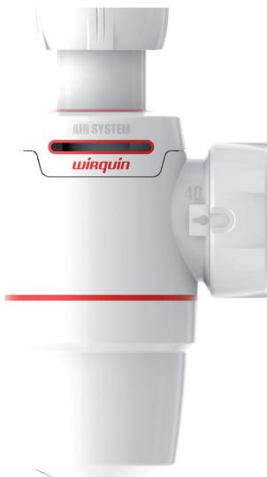
Garanti zéro fuite grâce à ses joints bi-injectés, Wirquin NEO AIR est fiable, rapide et facile à installer. Sa fonction AIR SYSTEM innovante et brevetée permet la ventilation des canalisations, empêche l'aspiration de la garde d'eau et supprime les bruits et les remontées de mauvaises odeurs provenant des canalisations. Le siphon Wirquin NEO AIR, c'est la garantie d'une installation fiable et efficace et du confort de l'utilisateur final.
