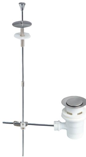
Cette bonde en plastique, conçue pour les lavabos à fermeture à tirette avec un trop-plein intégré, a un clapet rentrant en inox. Livrée avec chape de liaison. Plage de serrage : 28 à 45 mm.
