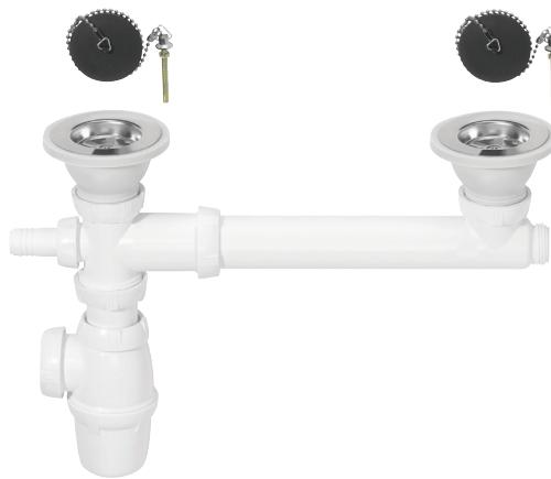
L'ensemble complet pour évier WIRQUIN comprend 2 bondes, un tube de raccordement, un trop-plein et un siphon classique conçu pour équiper les évier 2 bacs. Grâce à sa garde d'eau de 50 mm, le siphon est efficace contre les remontées d'odeurs.
