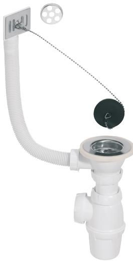
Cet ensemble complet, conçu pour équiper un évier Ø60, 1 bac, comprend une bonde et un siphon classique. Grâce à sa garde d'eau de 50 mm, le siphon est efficace contre les remontées d'odeurs.
