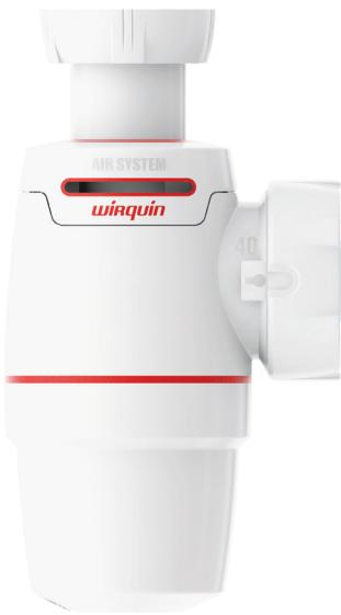
Garanti zéro fuite grâce à ses joints bi-injectés, Wirquin NEO AIR est fiable, rapide et facile à installer. Sa fonction AIR SYSTEM innovante et brevetée permet la ventilation des canalisations, empêche l'aspiration de garde d'eau et supprime le bruit et les mauvaises odeurs provenant des canalisations. Wirquin NEO AIR : la garantie d'une installation fiable et efficace et du confort de l'utilisateur final.
