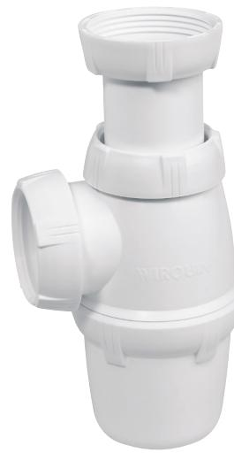
Ce siphon conçu pour équiper les évier, est classique et de qualité. Grâce à sa garde d'eau de 50 mm, il est efficace contre les remontées d'odeurs. Il est conforme à la norme EN274 et certifié NF.
