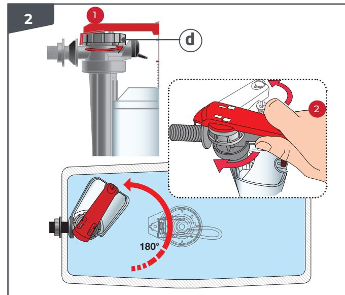
**FR INSTALLATION DU ROBINET :** ① placer le robinet dans le réservoir en enlevant au préalable l'écrou blanc ② et le visser à l'extérieur du réservoir en le serrant. Utiliser une clé afin de le raccorder à l'arrivée d'eau en serrant avec modération. NB : le joint étant intégré au robinet flotteur, s'assurer qu'il n'y en a pas d'autre avant raccordement à l'arrivée d'eau.
