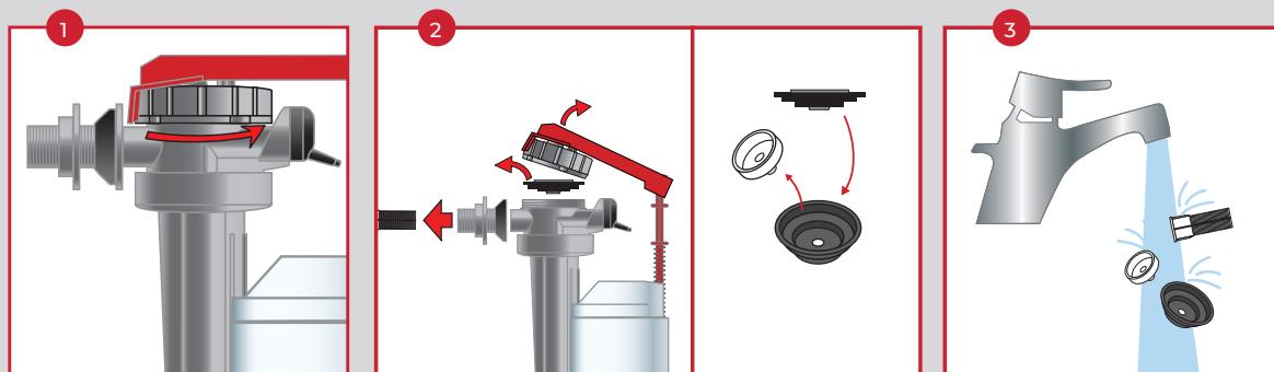
**FR ENTRETIEN :** il est recommandé un entretien régulier de votre robinet ou en cas de fuite. Retirer le joint servo-valve, l'insert et le filtre comme indiqué et passer les sous l'eau savonneuse. Les repositionner immédiatement.
