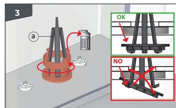
**FR** Dévisser l'ancien culot en maintenant le crochet **a**. Veiller au bon positionnement du crochet gris **a** afin qu'il bloque l'écrou sous le réservoir.
