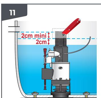
**FR** S'assurer que le haut du trop-plein est à minimum 2 cm au dessus du niveau d'eau et en dessous de l'ouverture pour raccordement du robinet.
