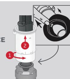
**FR** ENTRETIEN : il est recommandé un entretien de votre mécanisme tous les 5 ans ou en cas de légère fuite. Retirer le mécanisme en tournant 1/4 de tour, enlever le joint comme ci-contre et le nettoyer à l'eau savonneuse avant de le repositionner.
