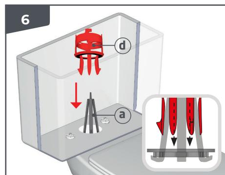
**FR** Insérer le culot harpon **d** à travers le trou du réservoir en maintenant le crochet **a**. Le centrer parfaitement dans l'axe du trou au fond du réservoir.
