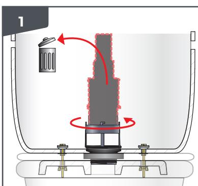
**FR** Retirer l'ancien mécanisme en prenant soin de laisser le culot (partie maintenue au réservoir).
