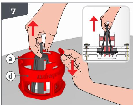
**FR** Tirez le crochet gris **a** vers le haut en vous assurant le bon positionnement de l'écrou et maintenir vers le bas le harpon rouge **d** jusqu'au clic. Votre culot harpon est cliqué sur l'écrou de l'ancien mécanisme. Retirer le crochet **a**.
