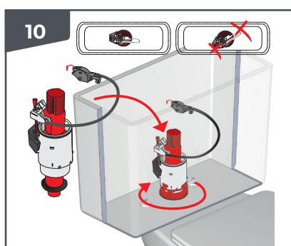
**FR** Insérer le mécanisme dans le culot et le fixer avec un quart de tour dans les sens des aiguilles d'une montre. Positionner le câble à l'opposé du robinet et libre de mouvement.
