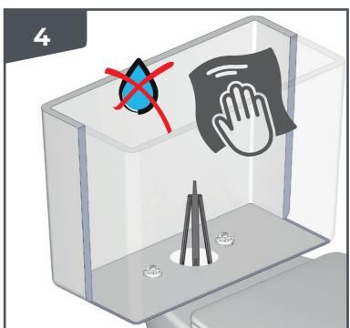
**FR** Sècher parfaitement l'intérieur du réservoir, si besoin à l'aide d'un séche cheveux. La surface de pose doit être complètement sèche.
