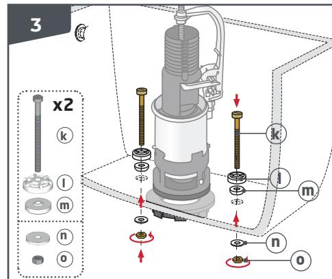
**FR VISSEUR DU RÉSERVOIR :** Positionner **(k)**, **(l)** et **(m)** à l'intérieur du réservoir et **(n)** en dessous puis serrer l'écrou **(o)**.
