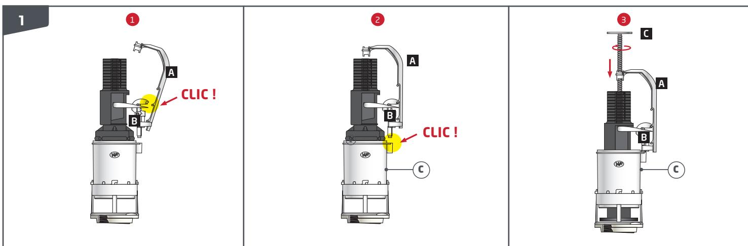
**FR FIXATION DE LA POTENCE :** ① Clipper A sur B en positionnant B sur la partie étroite du trop-plein, ② puis clipper l'ensemble sur C. ③ Visser la tige C.
