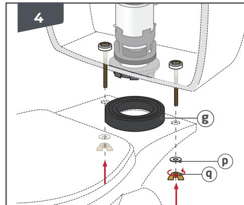
**FR FIXATION DU RÉSERVOIR :** Centrer **(g)** sur la cuvette. Fixer le réservoir avec les visseries **(p)** et **(q)**. Serrez fort de manière à écraser le joint **(g)**.
