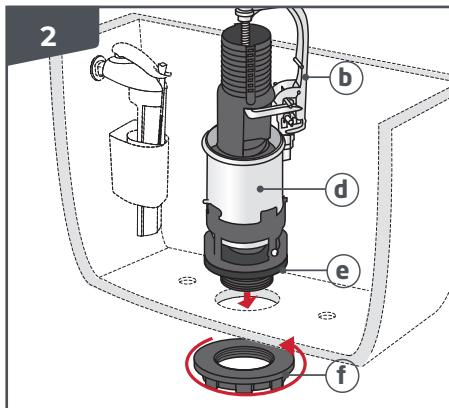
**FR FIXATION DU MÉCANISME :** Placer le mécanisme dans le réservoir en positionnant la partie **(b)** à l'opposé du robinet. Serrer l'écrou **(f)** à l'aide de l'outil **(e)**.
