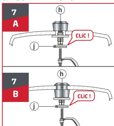
**FR MONTER LE BOUTON :** Enfoncer au maximum le plateau **(j)** sur le bouton **(h)**. Poser le couvercle sur le réservoir.
