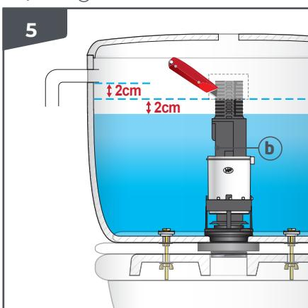
**FR VÉRIFICATION DU TROP-PLEIN :** s'assurer que le haut du trop-plein **(b)** est à minimum 2 cm au dessus du niveau d'eau et en dessous de l'ouverture pour raccordement du robinet.
