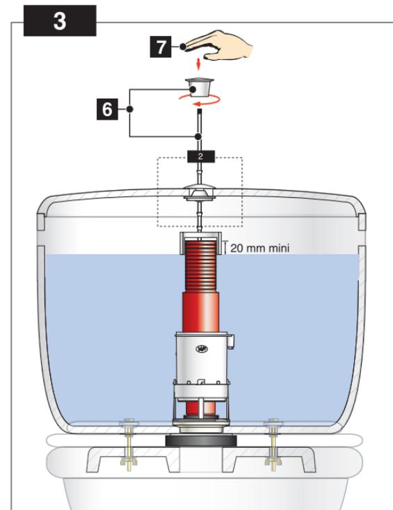
Pour régler la quantité d'eau évacuée, régler le niveau haut d'eau dans le réservoir avec le robinet de remplissage. **a** (voir au verso)
