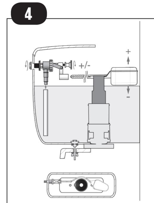
→ Pour régler la quantité d'eau évacuée, régler le niveau d'eau dans le réservoir avec le robinet de remplissage.
