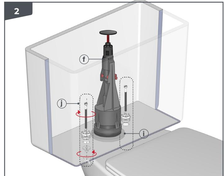
**FR** FIXATION DU CULOT : Placer le mécanisme (f) et le joint (g) au fond du réservoir. Serrer l'écrou (h) à l'aide de l'outil (k) fourni.
