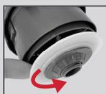
**EN** MANTENIMIENTO: recomendamos que realice el mantenimiento de la arandela de sellado de la válvula de descarga cada 5 años. Retire la válvula de descarga girando 1/4 de vuelta, retire la arandela de sellado como se muestra y límpiela con agua jabonosa antes de volver a colocarla. Inserte el mecanismo en la base y fíjelo con un cuarto de vuelta en el sentido de las agujas del reloj.
