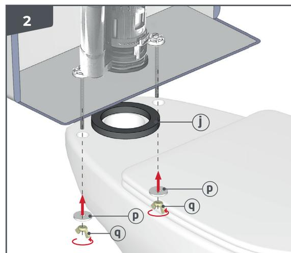
**FR FIXATION DU RÉSERVOIR :** Centrer (j) sur la cuvette. Fixer le réservoir avec les visseries (p) et (q). Serrer fort de manière à écraser le joint (j).
