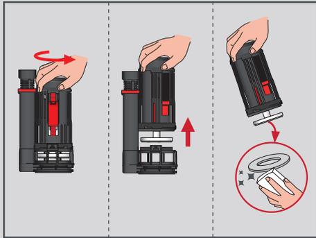
**FR ENTRETIEN :** il est recommandé un entretien de votre mécanisme tous les 5 ans ou en cas de légère fuite. Retirer le mécanisme en le tournant dans le sens anti-horaire, enlever le joint de clapet comme ci-contre et le nettoyer à l'eau savonneuse avant de le repositionner.
