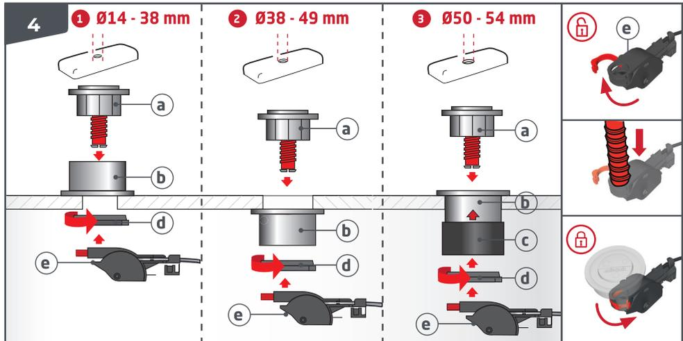
**FR FIXATION DU BOUTON :** en fonction du diamètre de votre trou de couvercle, assembler (a), (b), (c), (d) en suivant les étapes du cas 1, 2 ou 3. Puis ouvrir le clip (e), enfoncer le bouton (a) et refermer le clip (e). Votre bouton est installé. Repositionner votre couvercle sur le réservoir.
