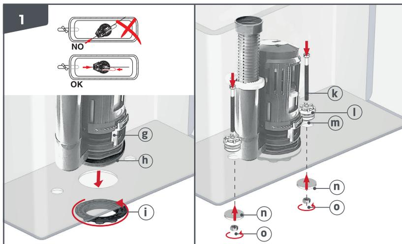
**FR FIXATION DU MÉCANISME :** Placer le mécanisme (g) et le joint (h) dans le réservoir en positionnant le câble à l'opposé du flotteur du robinet et libre de mouvement. Serrer l'écrou (i) à l'aide de l'outil (r). Positionner (k), (l) et (m) à l'intérieur du réservoir et (n) en dessous puis serrer l'écrou (o).
