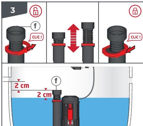
**FR VÉRIFICATION DU TROP-PLEIN :** vérifier que le haut du trop-plein (f) est à minimum 2 cm au dessus du niveau d'eau et en dessous de l'ouverture pour raccordement du robinet. Régler si nécessaire.
