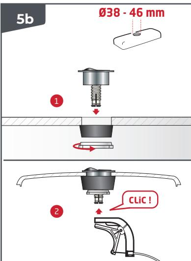
**FR** FIXATION DU BOUTON : Cas n°2 : le diamètre du trou de couvercle du réservoir compris entre 38 et 46 mm. La bague se place au dessous du couvercle.
