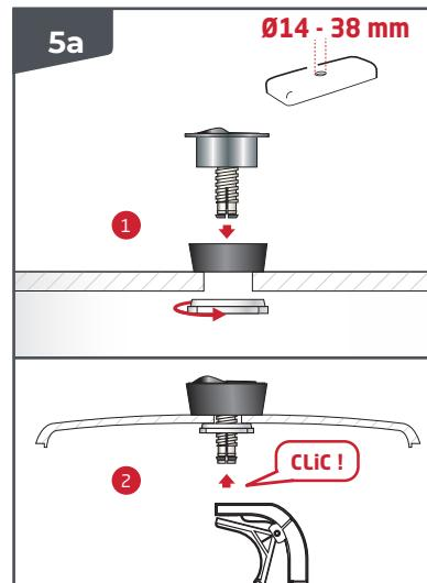
**FR** FIXATION DU BOUTON : Cas n°1 : le diamètre du trou de couvercle du réservoir compris entre 14 et 38 mm. La bague se place au dessus du couvercle.
