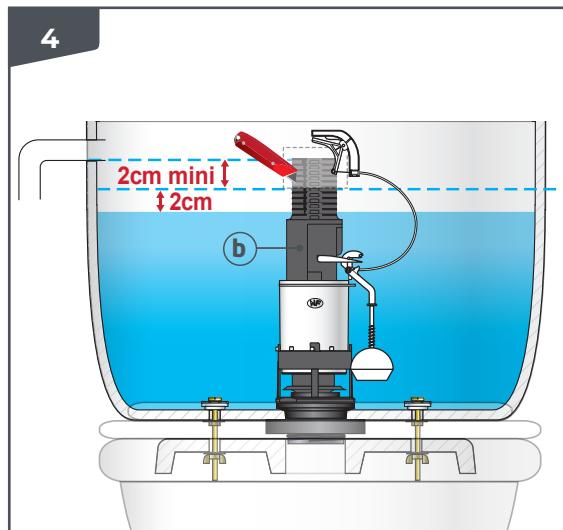
**FR** VERIFICATION DU TROP-PLEIN : s'assurer que le haut du trop-plein (b) est à minimum 2 cm au dessus du niveau d'eau et en dessous de l'ouverture pour raccordement du robinet.
