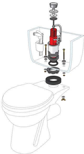
**MÉCANISME DE CHASSE D'EAU**
