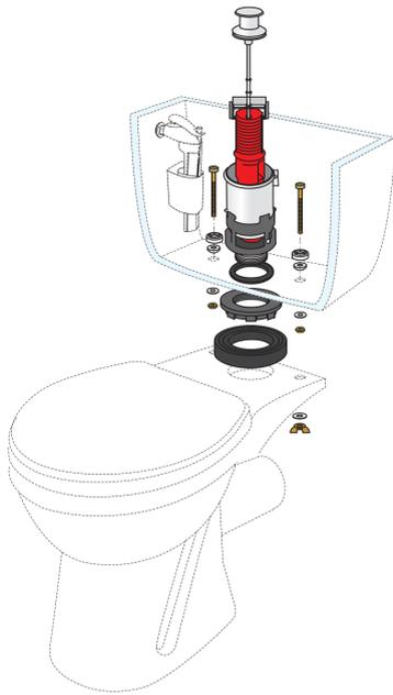
**MÉCANISME DE CHASSE D'EAU**
